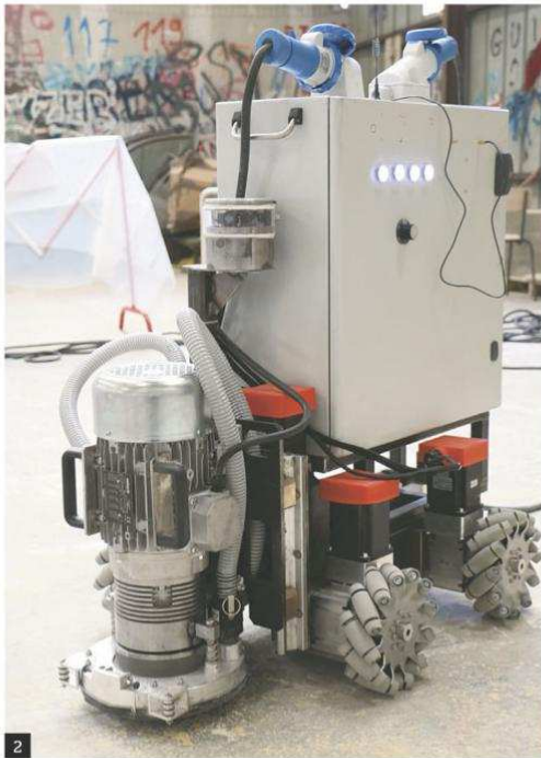
1 - Mis au point par SFTP, ce robot se repère dans une pièce et identifie les surfaces à poncer grâce à son laser 3D. 2 - Conçue pour poncer les colles amiantées au sol, Robotic Raboteuse devrait arriver sur le marché à l'été 2017. 3 - Adapté d'une table XY, ce système utilise une tête d'hydrodécapage robotisée et adaptable à différentes configurations. 4 - Cette ponceuse de colle au sol, au disque de 125 mm, est dédiée aux bordures des pièces.
